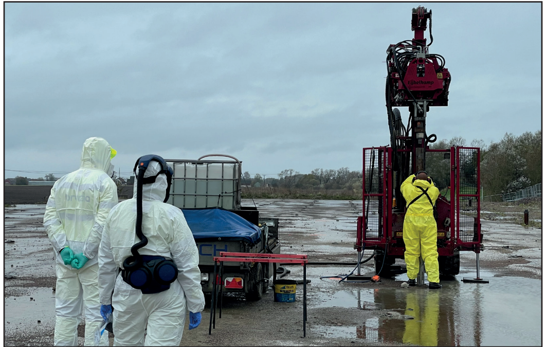
Ny provtagning i det termiskt behandlade området visar att bara en mindre del av massorna är förorenade med höga halter av dioxin. Under våren ska utredningsarbetet mynna ut i förslag på metoder för att hantera dem.
